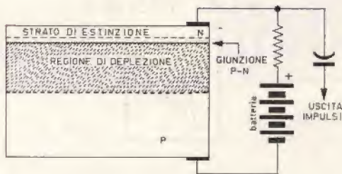
Principio di funzionamento di un rivelatore di radiazioni radioattive a semiconduttori.
